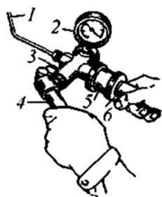
1 - топливопровод; 2 - манометр; 3 - насос; 4 - рычаг насоса; 5 - корпус; 6 - рукоятка
